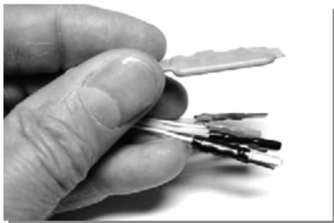
Контроллер LD-02 плавно включает ("мягкое включение") и выключает ("затухание" или "плавное гашение") свет в салоне автомобиля. Коммутирует мощность ламп до 20Вт.
