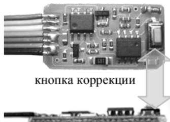
**ПРИМЕЧАНИЕ:** Выводы +12V и GND продублированы для удобства монтажа в автомобиле. Исполнения: «1 тип» и «2 тип» - отличия только в цветовой гамме проводов кабеля.
