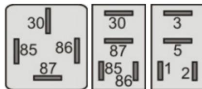
Рис 1. Соответствие выводов реле
