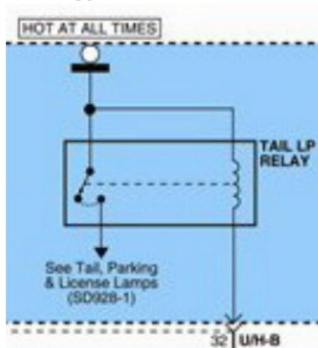
Рис. 6. Подключение реле с объединенными цепями силовых контактов и обмотки.
