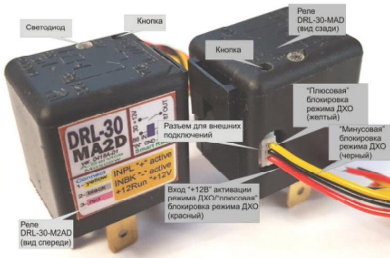
Рис 4. Внешний вид реле-контроллера DRL-30-MAD
