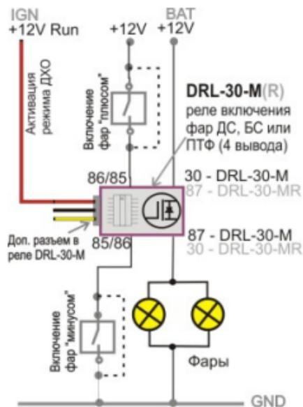
Рис. 3. «Простое подключение» DRL-30-MAD для управления фарами БС или ПТФ с обеспечением «Режима ДХО» - активация «режима ДХО» подачей «+12В» на красный провод доп. разъема реле, штатное включение фар – «минусом» или «плюсом».
