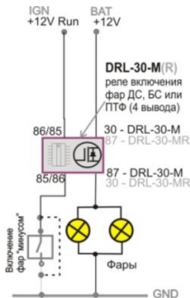
Рис. 7. Подключение реле в «Режиме 7»
