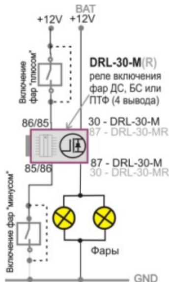
Рис. 8. Подключение реле в штатном режиме - без использования входов блокировки режима ДХО.
