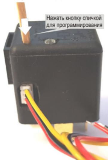
11-17. Задание порога для стабилизации-ограничения напряжения на лампах фар: при превышении напряжения борт.сети выше порогового уровня «излишки» напряжения будут «отсекаться» - яркость ламп останется на уровне заданного порога. (Заводская установка «16»).
